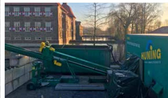
Vor Ort trennen mobile Zentrifugen Feststoffteile von der flüssigen Phase. Die anschließende Rekultivierung stellt bei der Verwertung des Schlammes ein Höchstmaß an Verantwortung dar.
