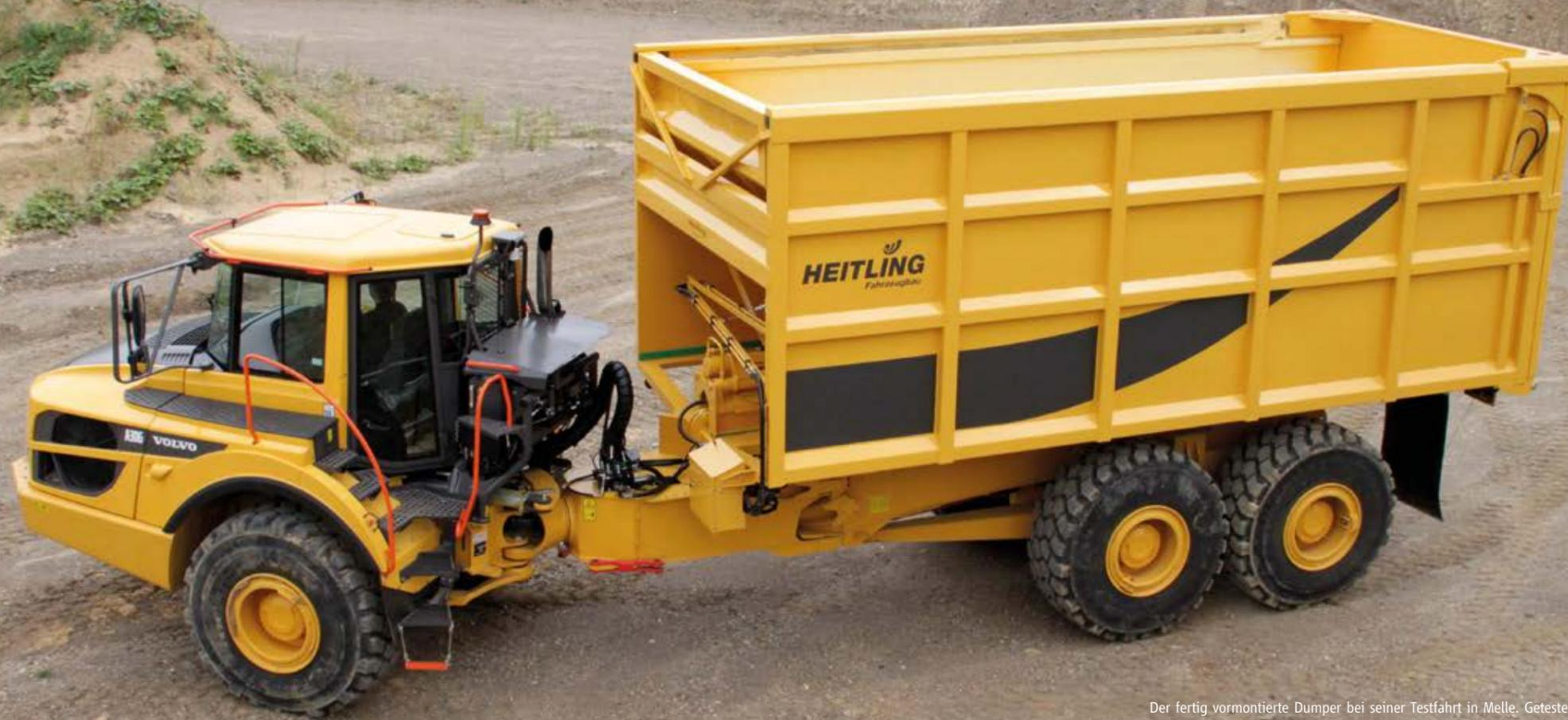
Der fertig vormontierte Dumper bei seiner Testfahrt in Melle. Getestet wurde das Abschieben verschiedener Schüttgüter und das Verhalten des Aufbaus in starkem Gelände.
