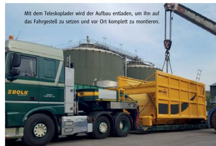
Mit dem Teleskoplader wird der Aufbau entladen, um ihn auf das Fahrgestell zu setzen und vor Ort komplett zu montieren.
